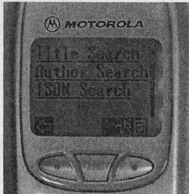
圖十五：實機（Motorola T191）顯示之選單卡
