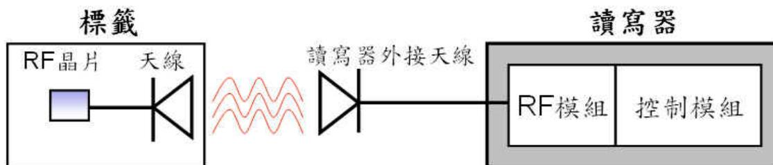
圖一：RFID 系統組成元件圖
