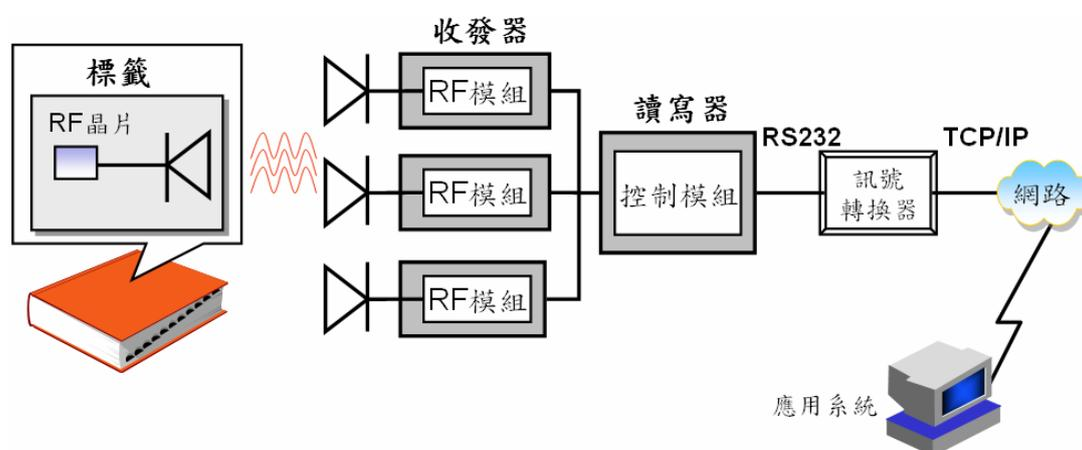
圖四：讀寫器與後端電腦接續方式的架構圖
