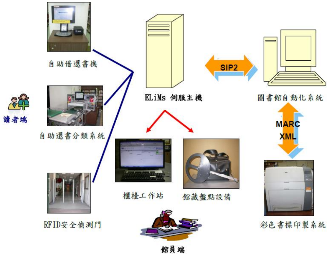
圖 7 國中圖 RFID 館藏流通系統架構圖
